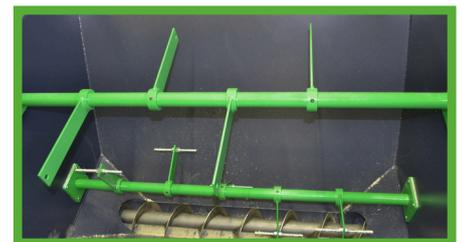
Integrierte Rührwerke verhindern effektiv die Brückenbildung bei sehr leichtem Material.
