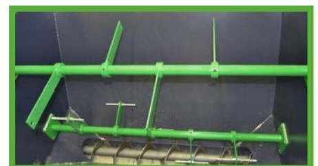
Integriertes Rührwerk zur Vermeidung von Brückenbildung bei sehr leichtem Material
