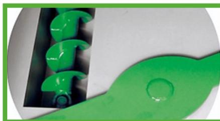
Mélangeur rotatif continu à vis d'extraction pour convoyage vers l'unité de pressage
