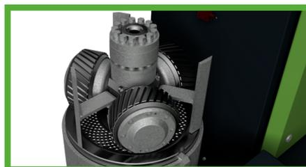
Das Pressraum optimierte Kollersystem gewährleistet maximale Laufruhe und hohe Produktivität.
