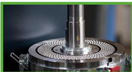
Das Herzstück der Pelletierung sind speziell gehärtete Flachmatrizen in unterschiedlichen Pelletdurchmessern und Presskanallängen.
