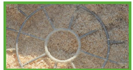
Der im Materialtrichter befindliche Mischer verhindert eine mögliche „Brückenbildung“ von sehr leichten Materialien. Des Weiteren sind am Mischer starke Magnete integriert, die mögliche Fremdkörper wie Nägel oder Metallspäne aussortieren können.
