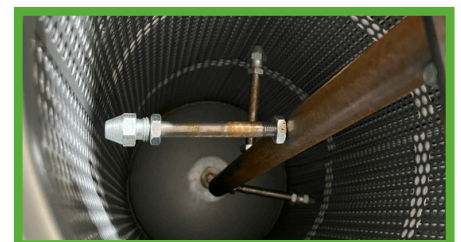
Abreinigbare Dauerfilterpatrone für geringe Verschleißkosten
