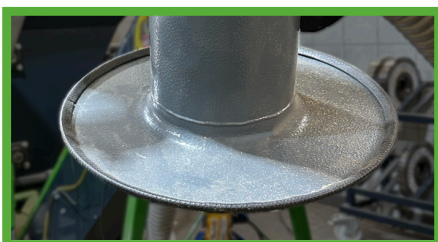
Punktabsaugung mit mind. 10 - 15cm Abstand zur Staubquelle
