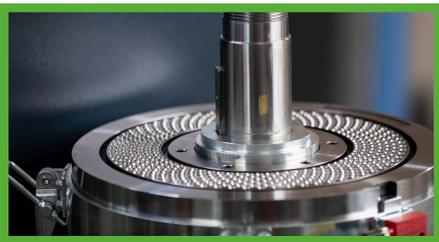
Hochwertig gehärtete Flachmatrizen für verschiedene Pelletdurchmesser und unterschiedliche Presskanallängen erhältlich.
