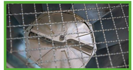
Der im Materialtrichter integrierte Mischer verhindert effektiv die „Brückenbildung“ von sehr leichten Materialien. Zudem sind im Mischer starke Magnete eingebaut, die potenzielle Fremdkörper wie Nägel oder Metallspäne größtenteils aussortieren können.
