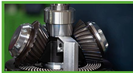
Das Kollersystem ist als durchdachte und langlebige Komplettseinheit konstruiert, die einen schnellen Wechsel ermöglicht und somit besonders benutzerfreundlich ist.
