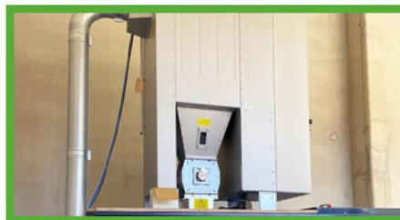
Die montierte Anlage ermöglicht einen einfachen Abwurf des zerkleinerten Materials.
